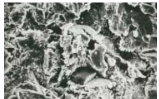
Superficie metallica trattata con MicroEtcher.
