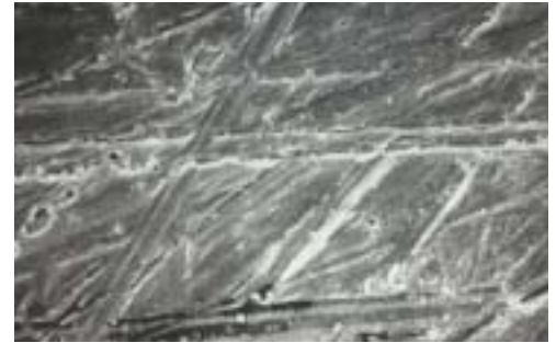
Superficie metallica irruvidita con fresa diamantata
