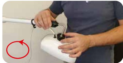
6. Conecte el cable de la parte superior del brazo angular al que sale del cabezal de blanqueamiento utilizando los conectores (véase la figura). Nota: el dispositivo no funcionará si los conectores de los cables no están colocados correctamente.
