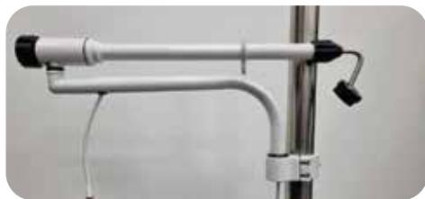
4. Utahováním aretačního šroubu (otáčením) můžete nastavovat polohu rovného ramena dolů a nahoru.
