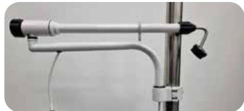
4. Stringendo il fissatore (tramite rotazione), è possibile muovere il braccio dritto verso l'alto e verso il basso per un posizionamento corretto.
