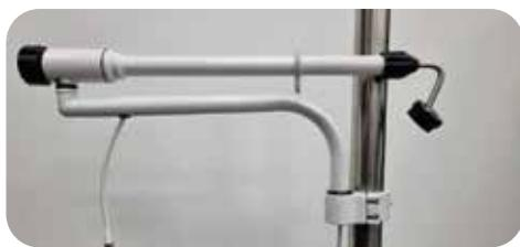
4. Ao apertar o mecanismo de fixação (romando), o braço horizontal pode ser levantado e baixado para o seu posicionamento.
