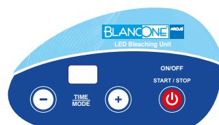
8. No final do dia, desligar o dispositivo mantendo premido o botão de ARRANQUE / PARAGEM durante 3-4 segundos ou desligá-lo da rede elétrica.
