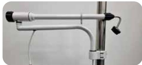
4. Al apretar el fijador (girando), el brazo recto puede moverse hacia arriba y hacia abajo para colocarlo.
