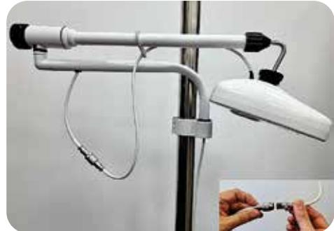
7. Conecte el cable de la parte inferior del brazo angular al adaptador mediante los conectores (véase la figura). Nota: el dispositivo no funciona si los cables no están colocados correctamente.
