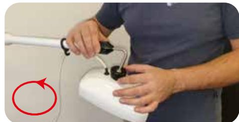
6. Ligar o cabo da parte superior do braço curvo ao cabo que sai da cabeça de branqueamento utilizando os conectores (ver figura). Nota: o dispositivo não funciona se os conectores dos cabos não estiverem corretamente posicionados.
