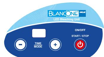
7. Herhangi bir anda cihazın durdurulması istenirse, BAŞLAT / DURDUR butonuna basılması gereklidir. Cihaz manuel olarak durdurulmaz ise, seçilmiş olan süre dolduktan sonra cihaz kendiliğinden duracaktır. Üniteyi soğutmak için fanların bir süre için çalışmaya devam edeceklerine dikkat edin.
