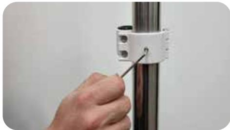
3. Zasuňte kábel cez malý otvor v upevňovacej spojke a osadte obidve ramená
