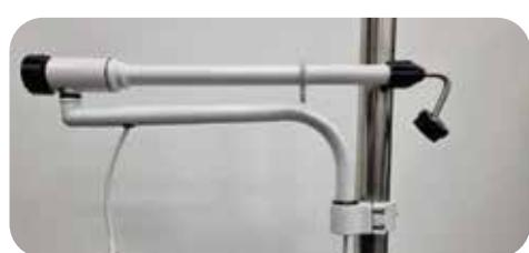
4. Dokręcanie (obracanie) stabilizatora sprawia, że ramię proste może przesuwać się w dół i w górę w celu pozycjonowania.
