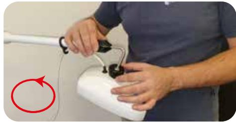
6. Forbind kablet fra toppen af vinkelarmen til det, der kommer fra blegehovedet, ved hjælp af stikkene (se figur). Bemærk: Enheden fungerer ikke, hvis kabelstikkene er forkert tilkoblet.
