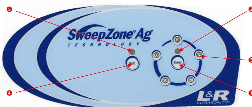
Il pannello digitale L&R gestisce il funzionamento e le varie opzioni delle pulitrici ad ultrasuoni L&R. Ci sono tre aree di controllo: l'Interruttore Generale, il Timer, il Riscaldamento.
