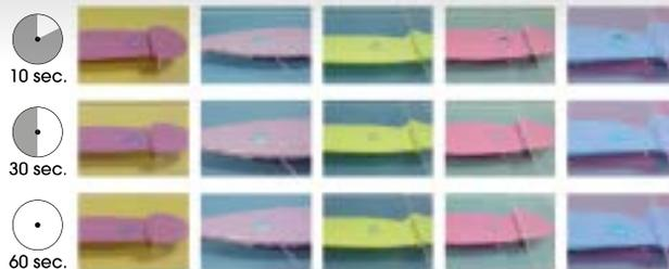
Oservazione dell'angolo di contatto di una goccia d'acqua durante la fase di presa. L'elevata idrofilia di un materiale durante la presa assicura un'elevata precisione.
