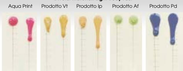
A - Compattezza e stabilità del materiale posto in posizione verticale per 60 secondi.
